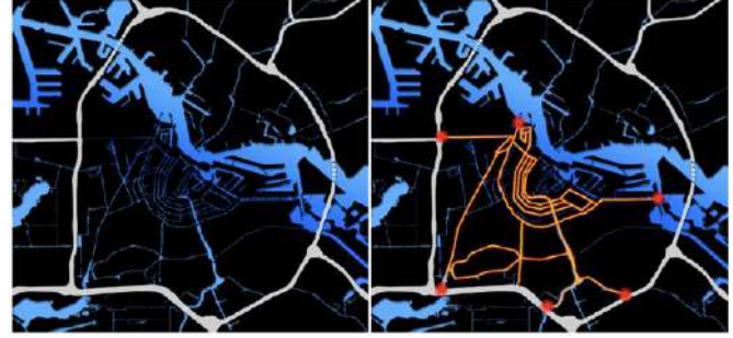
Şekil 13 AMFORA Planı Kapsamında Oluşturulan Tünel ve Yol Aęı Sistemi (Jansma, 2009)
